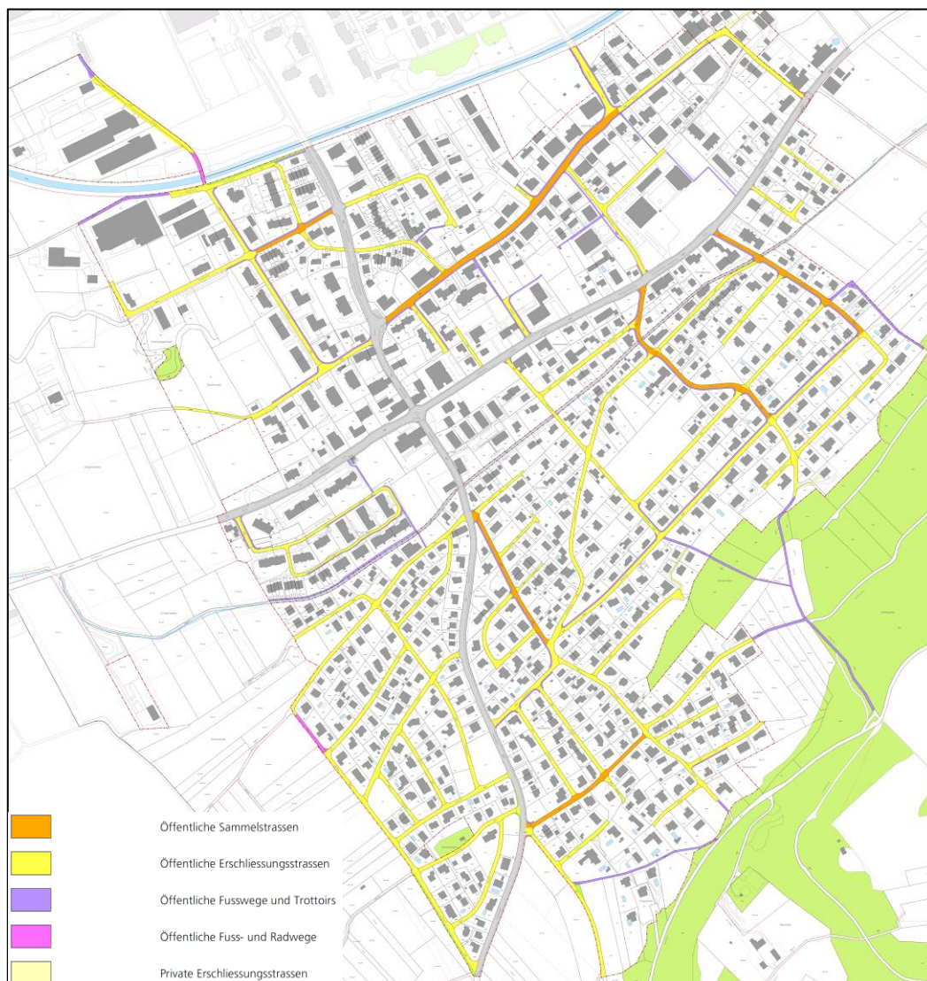
Abbildung 1: Strassenklassierung gemäss Erschliessungsplan mit Baulinien und Strassenklassierung der Ortsplanungsrevision Kappel (Stand Mitwirkung)
